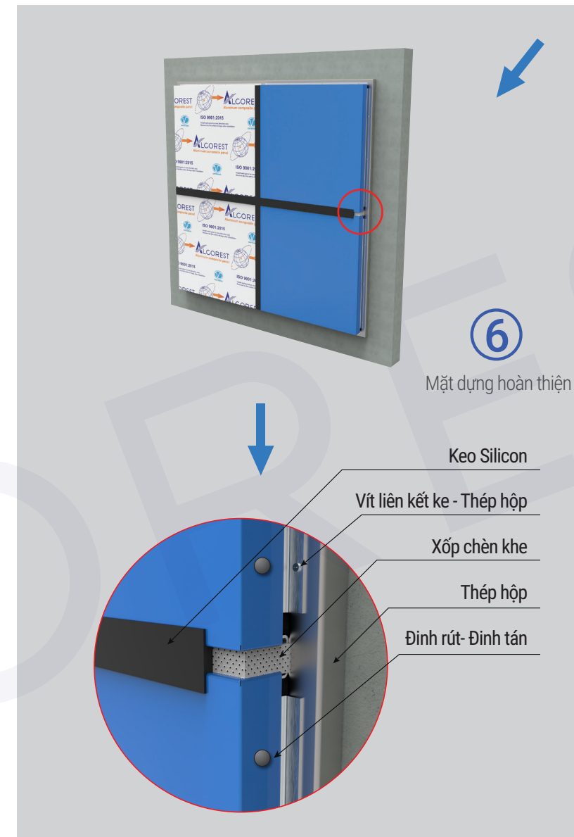
Hình 5.2c: Thi công ốp tấm bằng phương pháp gấp hộp bẻ ke
